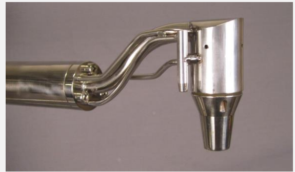
Rakt spetshuvud till sond ESS-P med totaltryckrör för simultan flödesmätning
